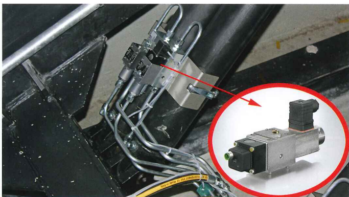
Bei der neuen Lösung wurden mit dem Wegesitzventil NBVP 16 mit Stellungenüberwachung umfassende Sicherheitsfunktionen direkt an die Zylinder verlegt. Zur Vorbereitung gehörte auch die Vorabfabrikation der gesamten Befestigungstechnik sowie der Verrohrung.
