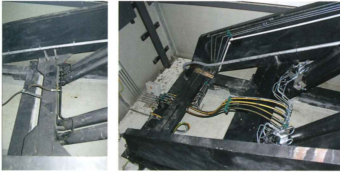
Hydraulische Anschlüsse Hauptzylinder: Der Vergleich des alten Zustands (links) mit der jetzigen Situation zeigt deutlich die umfassenden Verbesserungen.
