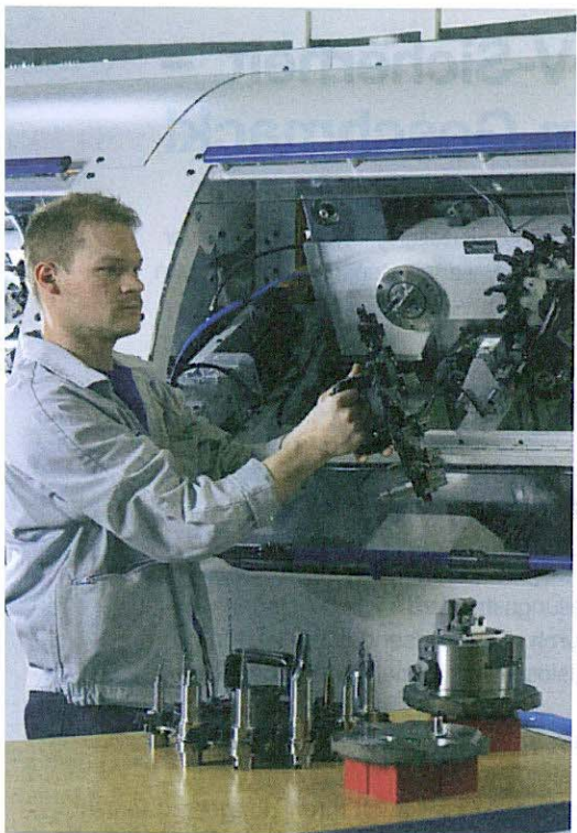
Bild 3: Hohe Flexibilität durch schnelle Umrüstung: Anwender fertigen bis zu 100 verschiedene Produkte auf einer Maschine
